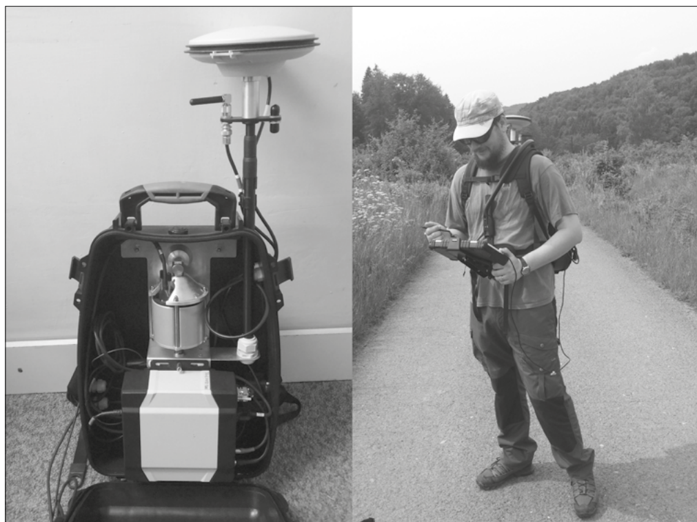
Obr. 1. Použitý nesený inerciálny navigačný systém (foto: J. Tomašík, Š. Saloň)
