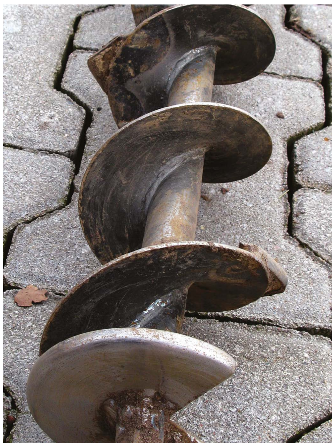
Obr. 1. Konstrukční úpravy půdních vrtáků pro výsadbu lesních dřevin zamezující ohlazování stěn vrtaných jamek
