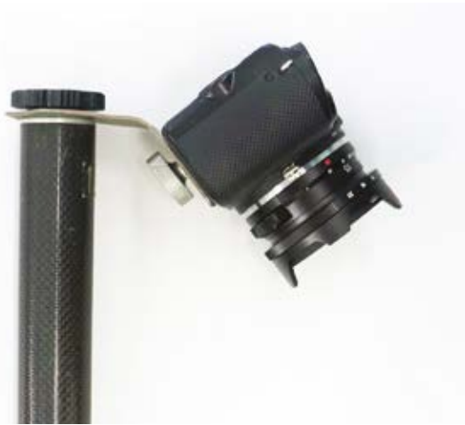
Obr. 1. Detail uchycení fotoaparátu pomocí držáku na výtyčce (foto: T. Mikita)
