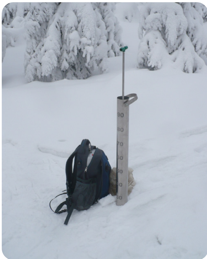
Obrázek 3.1: Odběrný válec pro měření výšky a vodní hodnoty sněhu
