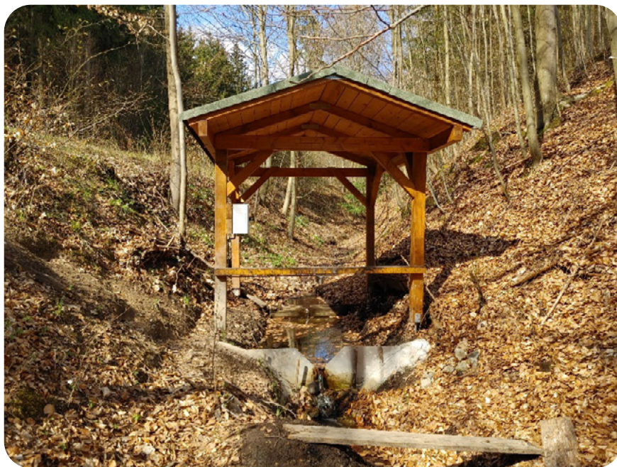
Obrázek 6.4: Kompletně osazená hladinoměrná stanice na drobném lesním toku, ŠLP ML Křtiny
