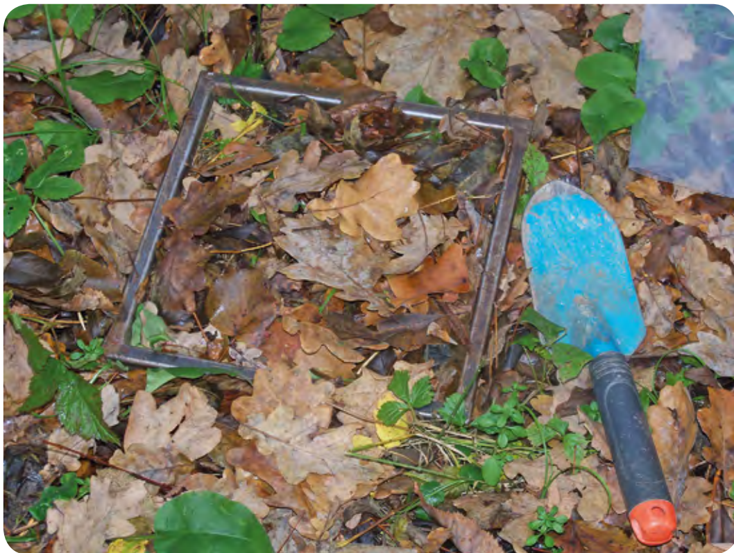
Obr. 3.3.17: Odběr vzorku humusu pro stanovení objemové hmotnosti. / Sampling of organic horizon for bulk density estimation.
