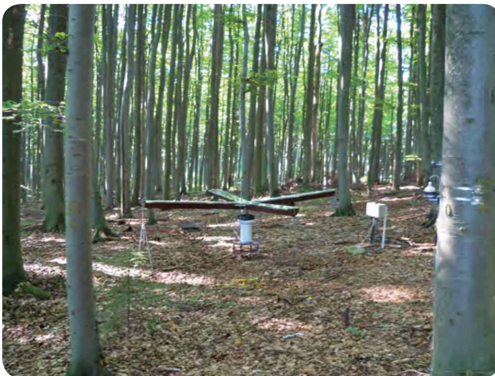
Obr. 3.2.26: Měření porostních srážek a půdních vlastností v lesním porostu – Q103 Všetec. / Measurement of throughfall and soil parameters in the forest stand – Q103 Všetec.
