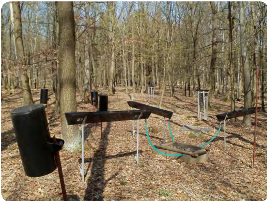
Obr. 3.3.1: Koryta pro odběr srážek v porostu. / Gutters for throughfall sampling.
