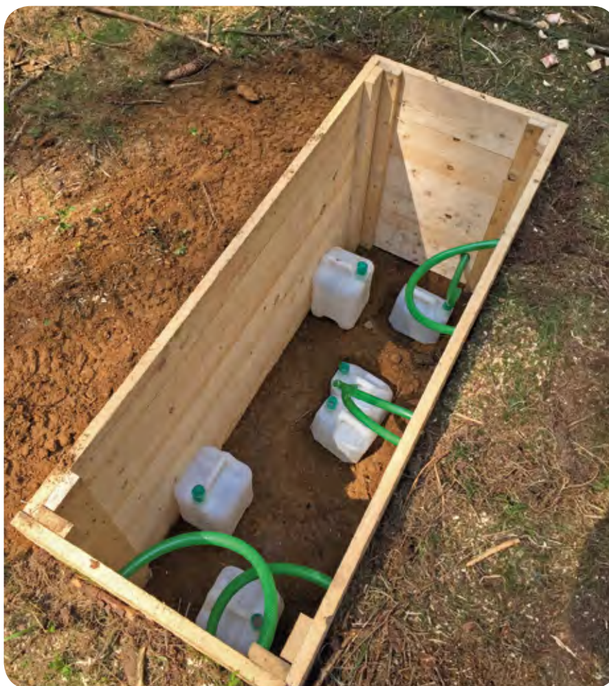
Obr. 3.3.9: Sonda se zásobními nádobami pro odběr vzorků půdní vody. / Soil pit with the storage bottles for soil solution sampling.
