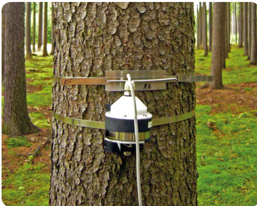
Obr. 3.2.16: Elektronický dendrometr DR 26 a pásový dendrometr s manuálním odečtem (plocha I140 Želivka). / Electronical dendrometer DR26 and permanent girth band (plot I140 Želivka).
