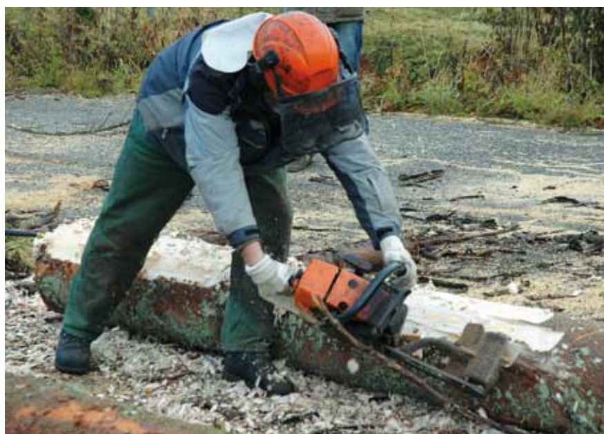
Odkorňování adaptérem na motorovou pilu
