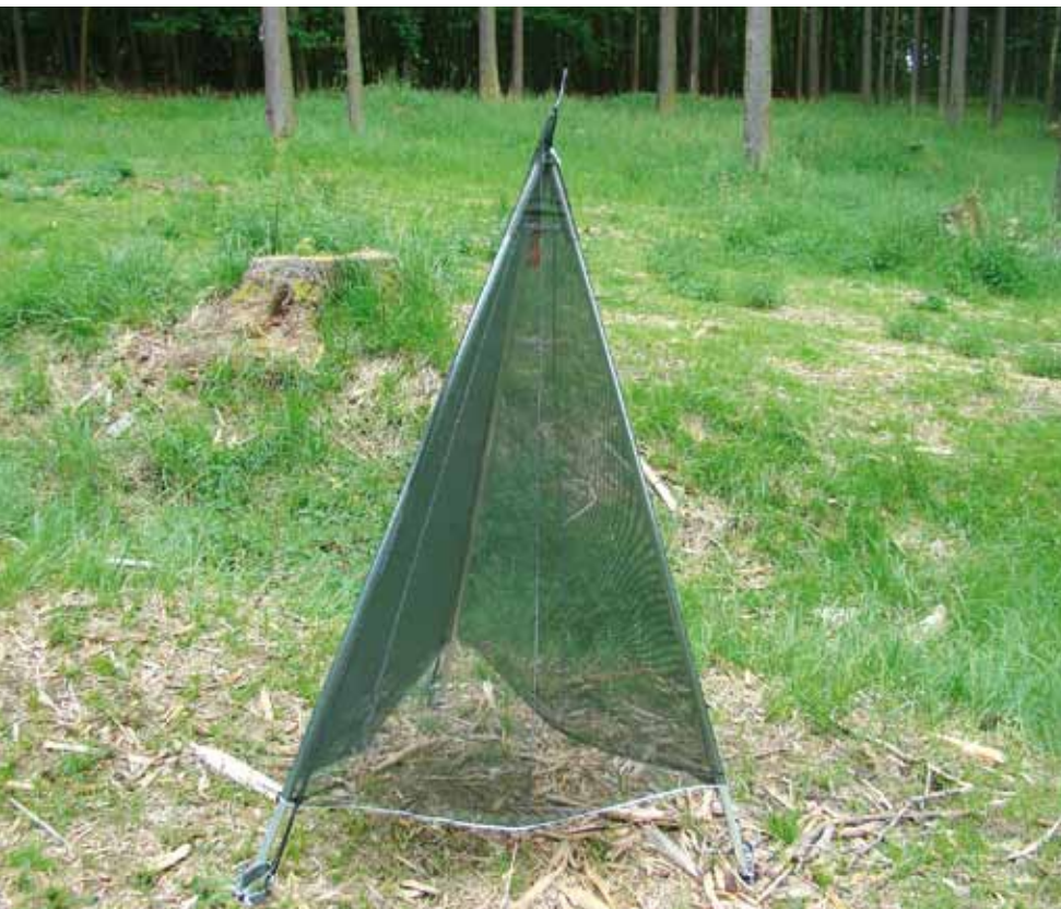
Otrávený lapák – systém Trinet-P
