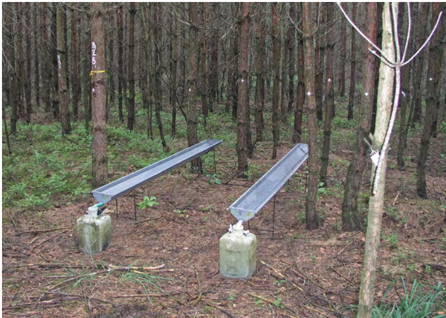
Obr. 7: Měření podkorunových srážek v mladém borovém porostu.
