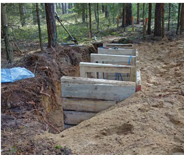
Obr. 3: Založení lyzimetrických sond v experimentu zaměřeném na sledování vlivu smrkové etáže borového porostu.
