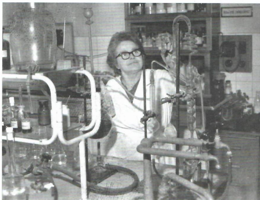
Paní Růžena Vostárková při stanovení dusíku na Parnass-Wagnerově přístroji, 1967.
