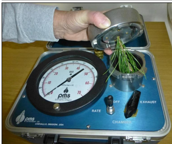
Měření vodního stresu tlakovou komorou ve Výzkumné stanici Opočno, archiv VÚLHM
