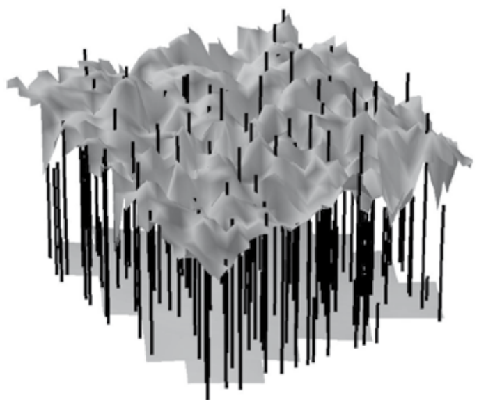
Obr. 2. Ukázka interpolovaného rastru nástrojem Natural Neighbour dále vyhlazeného nástrojem Focal Statistics Fig. 2. Example of interpolated raster by Natural Neighbour consequently smoothed by Focal Statistics
