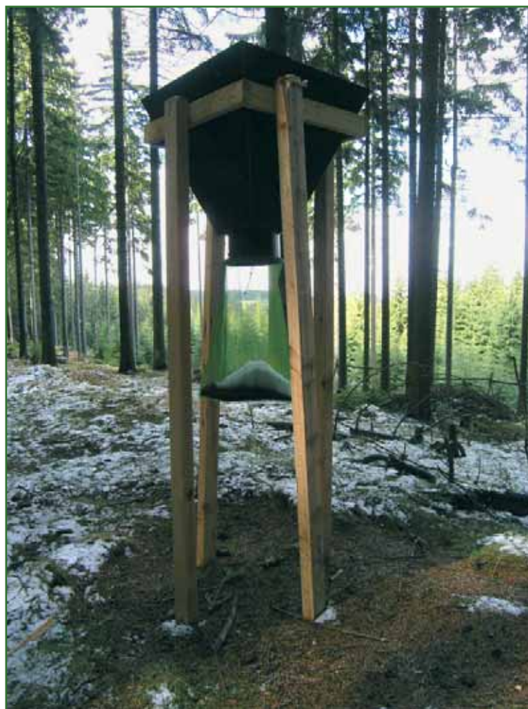
Foto. 4.2.14.1: Opadoměr Litterfall collector
