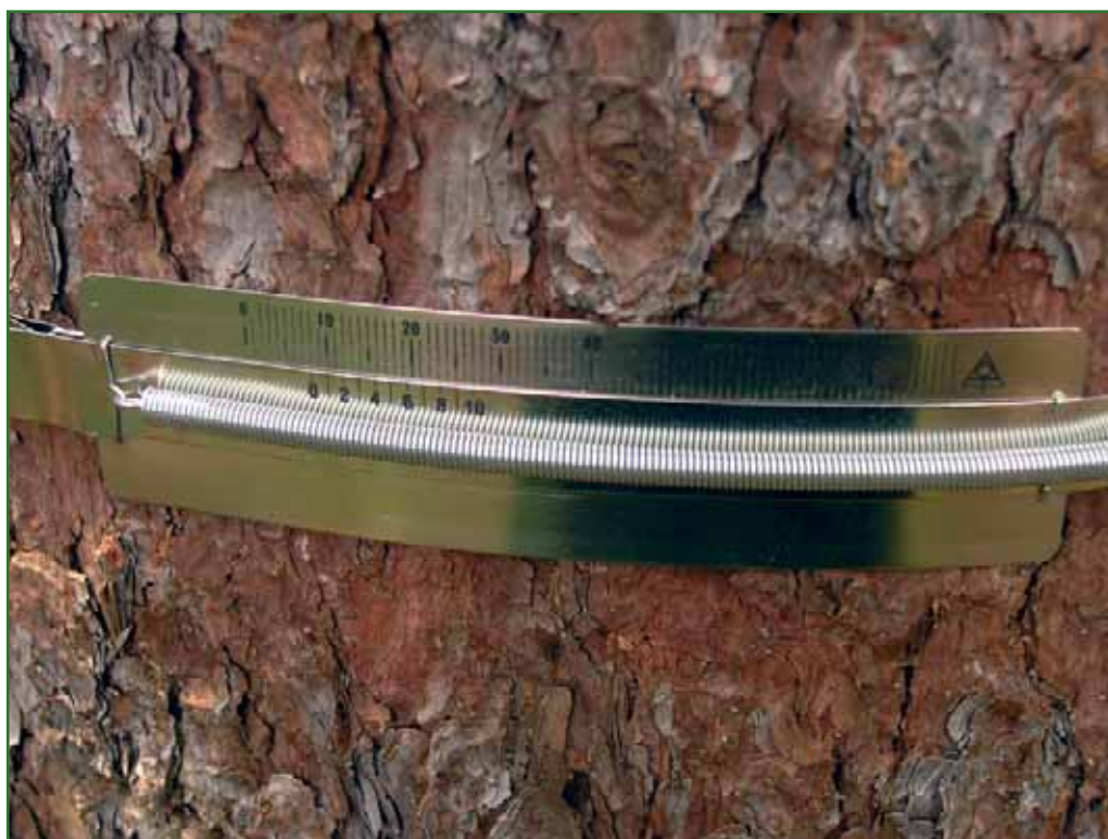
Foto 5.11.4: Detail přírůstoměru Detail of dendrometer
