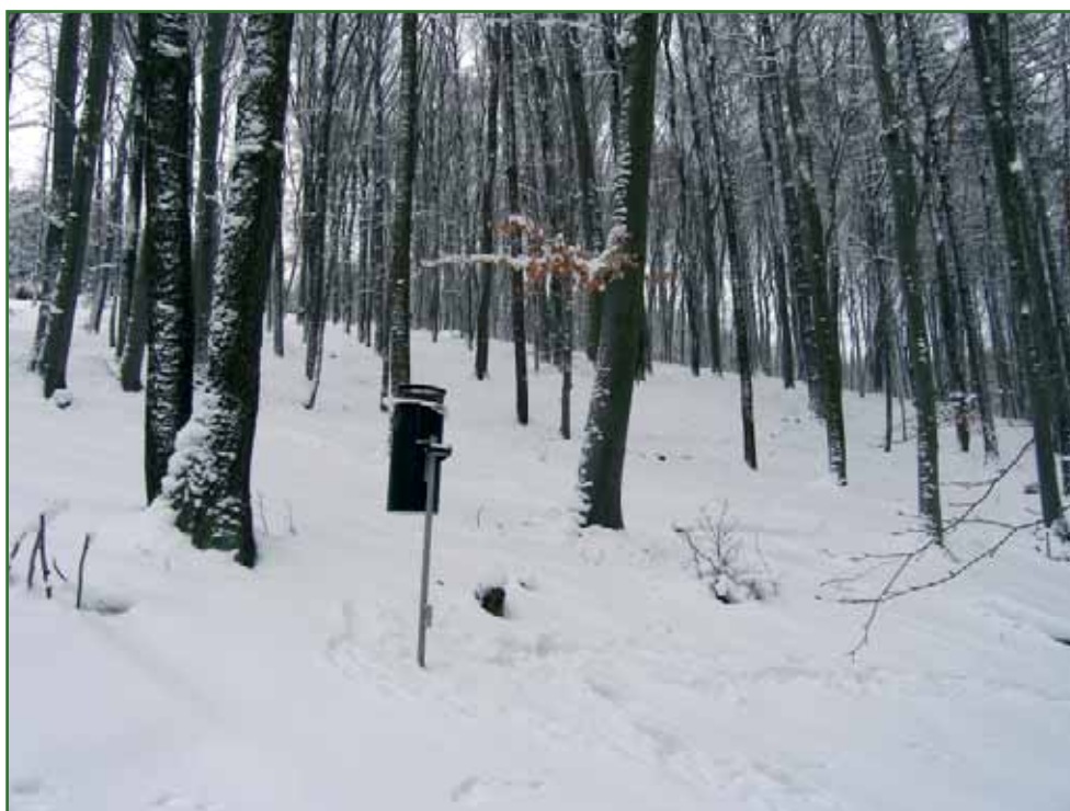
Foto 4.2.12.1: Zimní měření depozic na ploše Medlovice Snow samplers at the plot Medlovice
