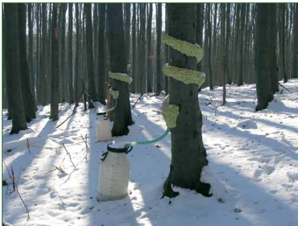
Foto 4.2.5.3: Zamrzlé zařízení pro odběr vody stékající po kmeni na ploše Všetec Frozen stemflow samplers at the plot Všetec
