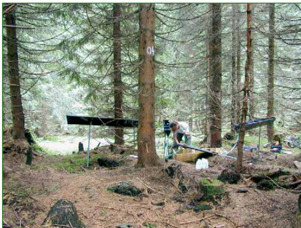
Foto 4.2.9.1: Instalace měřicího zařízení pro odběr podkorunových srážek na ploše Jizerka Installation of throughfall collectors at the plot Jizerka
