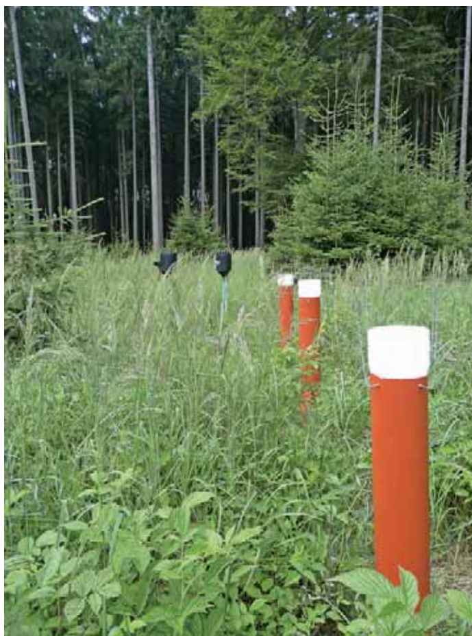
Obr. 2.22: Rozmístění národních a standardizovaných odběrových nádob na volné ploše / Distribution of the national and standardized international containers in open plot
