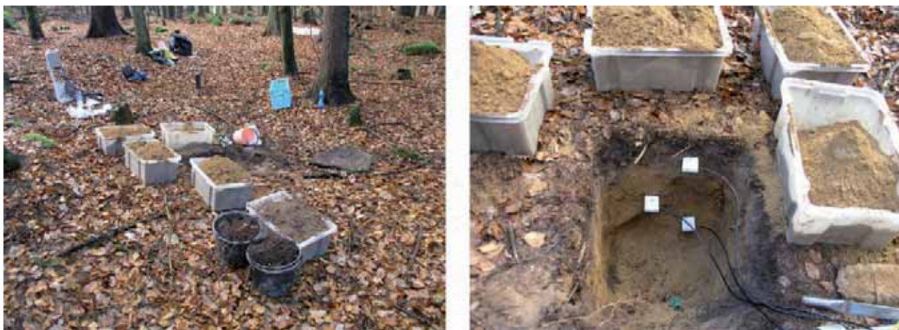
Obr. 5.1: Instalace čidel objemové vlhkosti půdy na ploše Lásenice / Installing of the sensors of soil moisture
