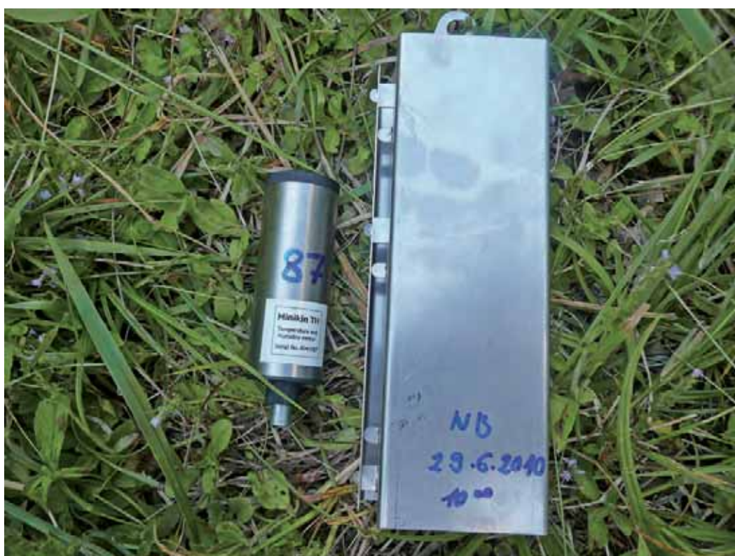
Obr. 2.21: Čidlo na měření teploty a vlhkosti Minikin TH EMS Brno / Sensor of temperature and moisture measuring Minikin TH EMS Brno
