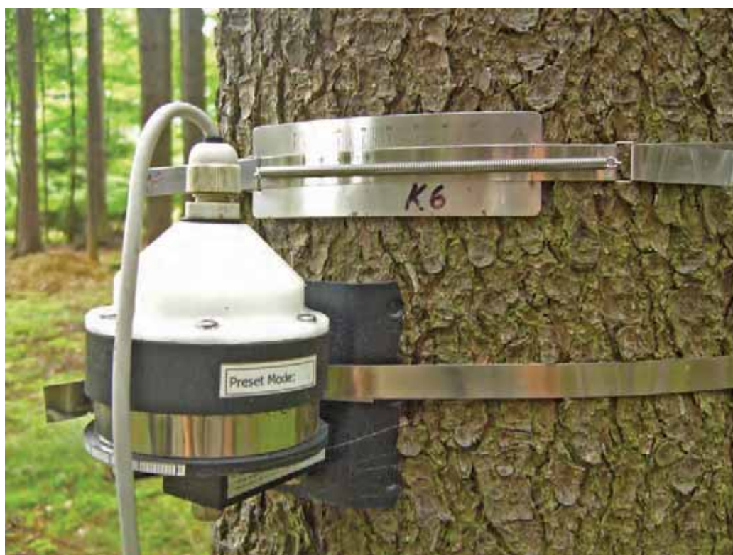
Obr. 3.9: Elektronický dendrometr DR 26 a pásový přírůstoměr s manuálním odečtem (plocha I140 Želivka) / Electronical dendrometer DR26 and permanent girth band (plot I140 Želivka)
