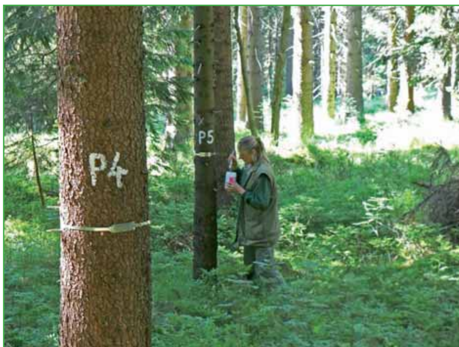
Foto: Odečet hodnot na přírůstoměrech Reading of dendrometers
