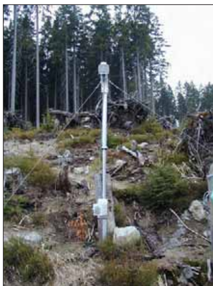
Obr. 5.2.1.1 Automatická stanice na měření meteorologických dat Automatic measuring station
