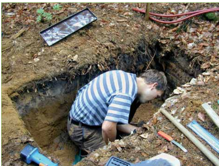
Obr. 5.2.5.5 Instalace lyzimetrů Installation of lysimeters
