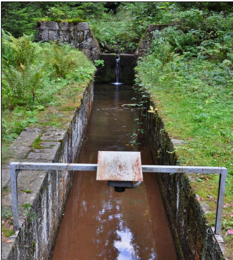
Sonda na měření výšky hladiny průtoku vody v povodí Červík, foto archiv VÚLHM
