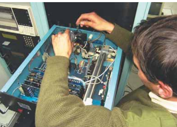
Lazy – údržba meteostanice – výměna čerpadla
