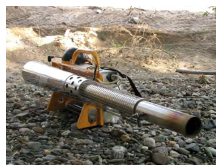
Zmlžovač Igeba k rozprašování insekticidu
