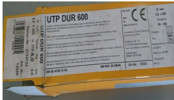
Obr. 3: Elektrody vhodné k navaření vrtáků
