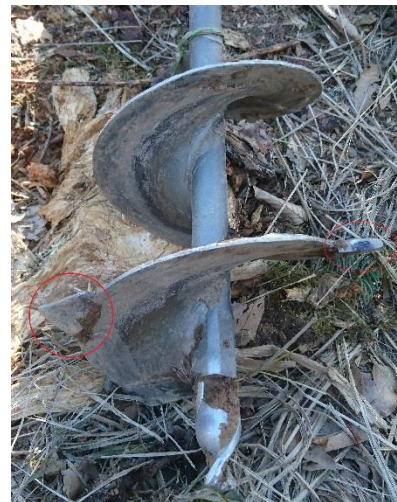
Obr. 4: Šroubovice vrtáku s navařenými výstupky z tvrdokovu
