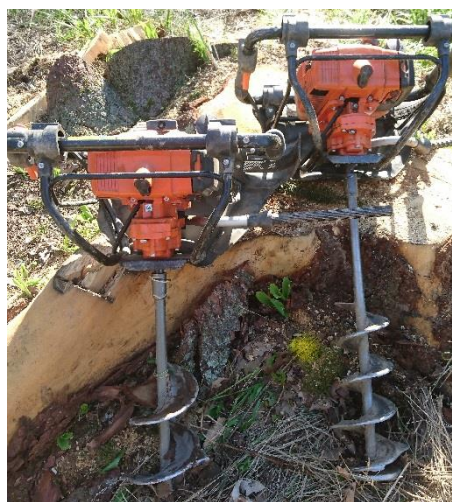
Obr. 1: Provozně odzkoušené půdní vrtáky značky STIHL s vrtákem o průměru 15 cm a 12 cm
