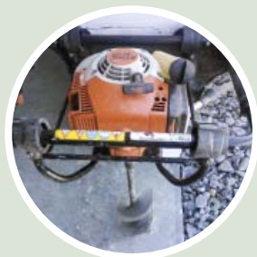
Provozně odzkoušené půdní vrtáky značky STIHL. Na snímku je patrné ovaření šroubovic tvrdokovem a navaření rozbrušovacích hrotů.
