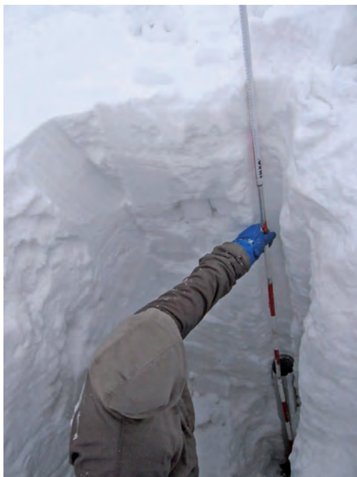
Obr. 12: Postupné odebrání sněhového sloupce
