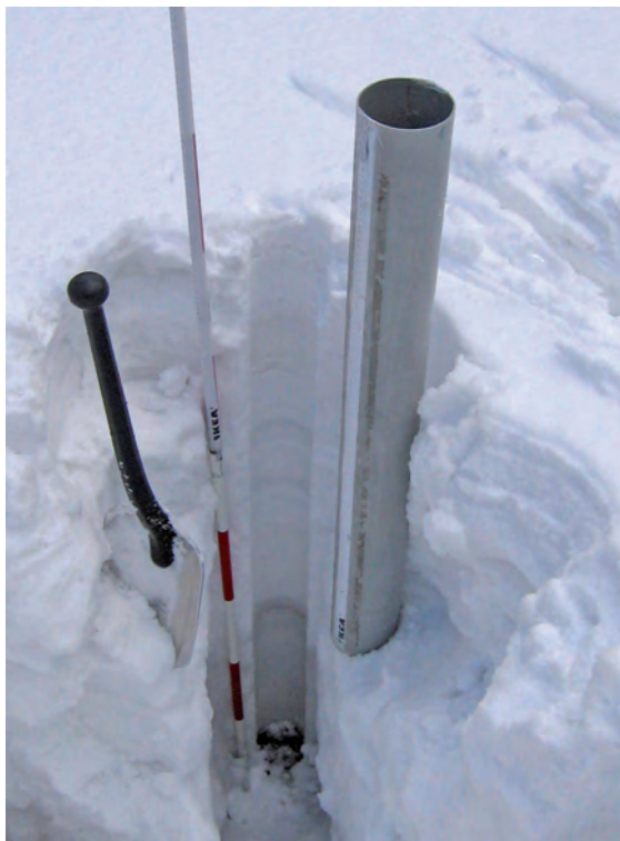
Obr. 11: Sonda po odběru vzorku odběrným válcem (rourou)
