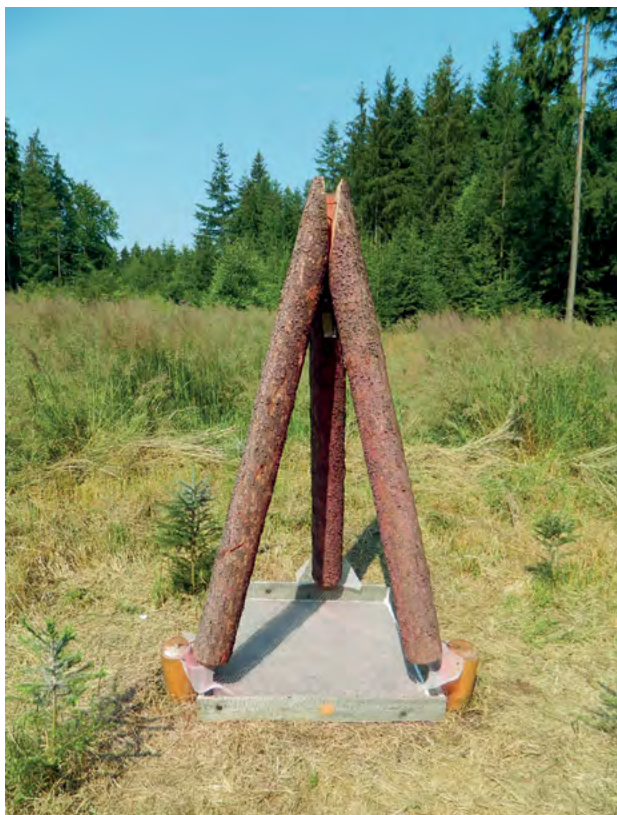
Obr. 3: Experimentální trojnožka spojená hřebíky.
