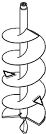
Obr. 1: Náskres úpravy spirálového vrtáku pro zamezení ohlazování stěn výsadbové jamky.
