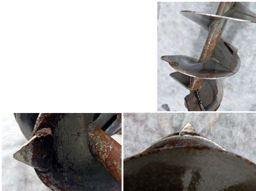
Obr. 2: Půdní vrták zamezující ohlazování stěn vrtaných jamek – pevné přivaření dvou vystupujících kovových trojúhelníkových trnů, umístěných ve spodní části vnější spirály vrtáku.
