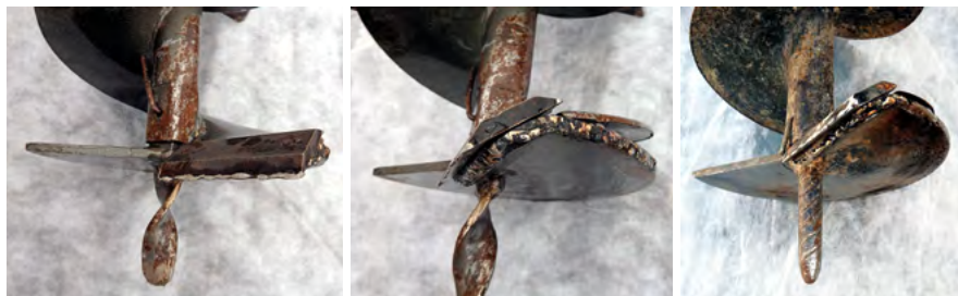
Obr. 3: Půdní vrták – detail hrotu vrtáku a řezacího nože, detail ovaření obvodu spirály tvrdokovem, náhrada hrotu vrtáku ocelovým betonářským výztužným prutem.
