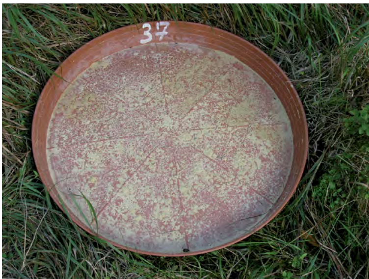
Obr. 5: Odběrová nádoba částečně vymytá srážkami (Foto: V. Šrámek)
