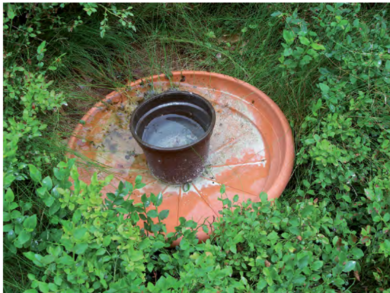
Obr. 7: Upravená odběrová nádoba pro kontrolu úplnosti zásahu (Foto: V. Šrámek)
