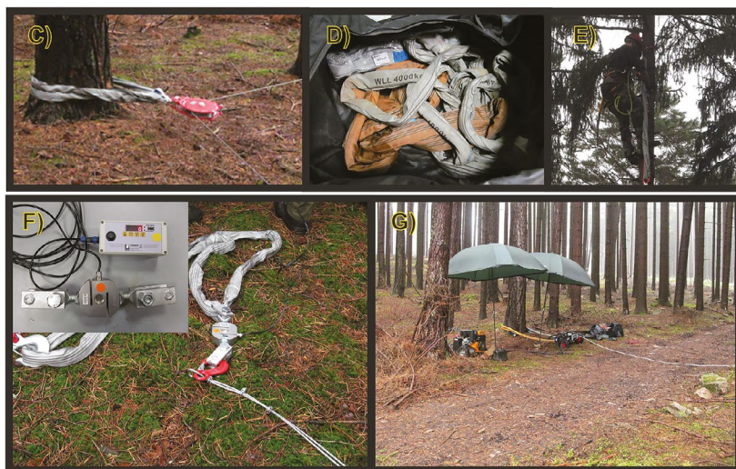
Obr. 4: Schéma průběhu tahové zkoušky (A); (B) Měřené veličiny v průběhu zkoušky ( h – výška stromu, h_t – těžiště koruny, \beta_0 – inklinace báze stromu, \beta_f – úhel napínání lana, F_h a F_v – horizontální a vertikální složky napínací síly F ); (C) detail směrové kladky; (D) úvazky; (E) umístění úvazku v koruně pomocí lezecké soupravy; (F) tenzometr; (G) Celá zapojená a ukotvená sestava Stromotruh zakrytá v nepříznivém počasí deštníky
