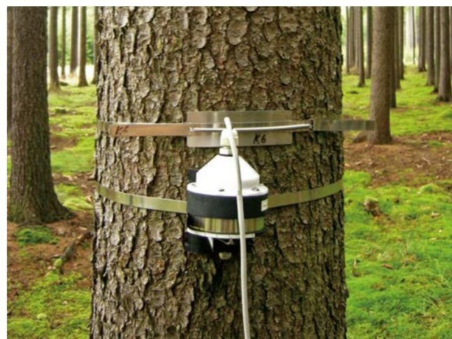
Obr. 1: Umístění dendrometrů na plochách. V horní části kmene manuálně odečítaný, pod ním elektronický dendrometr.
