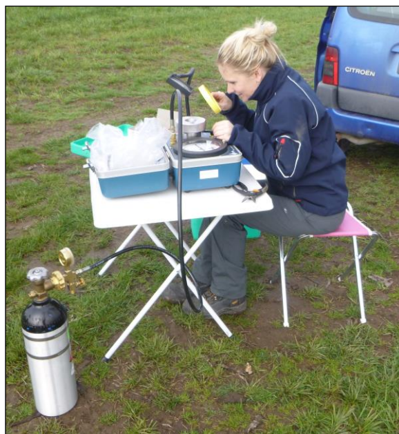
Obr. 3: Terénní měření vodního stresu PMS tlakovou komorou
