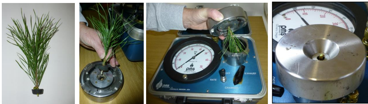
Obr. 2: Postup měření vodního stresu PMS tlakovou komorou
