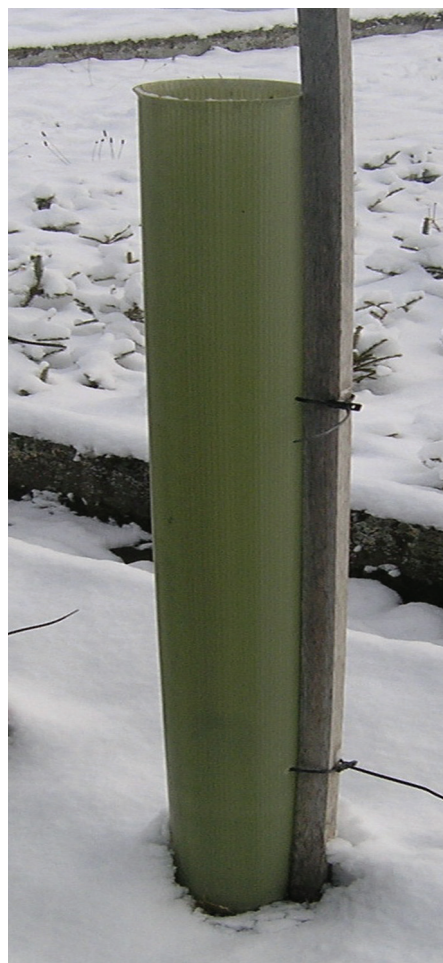
Obr. 1. Typ chrániče použitý pro hodnocení teplotních podmínek (neperforovaný) Treeshelter where temperature conditions were monitored (unventilated)
