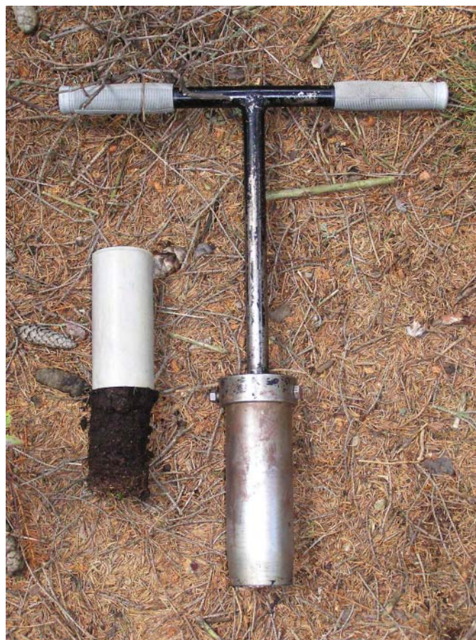
Obr. 3. Sonda k odběru kořenů, plastická vložka s odebraným vzorkem Sampling tool (borer) with soil sample in plastic compartment
