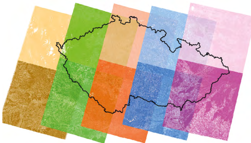
Obr. 2: Scény družice Landsat pokrývající ČR. Barevně jsou odlišeny jednotlivé scény. Tento systém je platný pro všechny družice systému Landsat.
