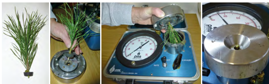
Obr. 2: Postup měření vodního stresu PMS tlakovou komorou
