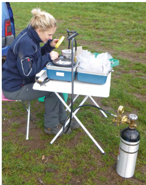
Obr. 3: Terénní měření vodního stresu PMS tlakovou komorou
