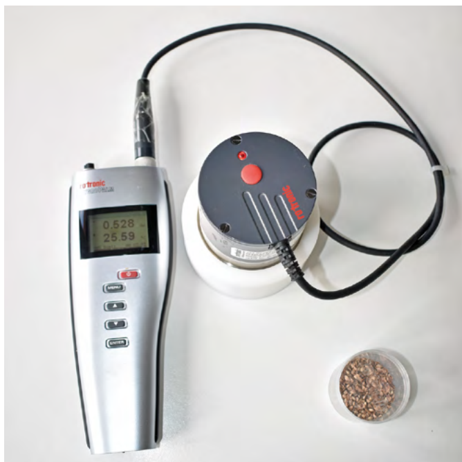
Obr. 2. HP23 – AW-SET_sada pro měření vodní aktivity od firmy ROTRONIC (foto S. Panáčková)
