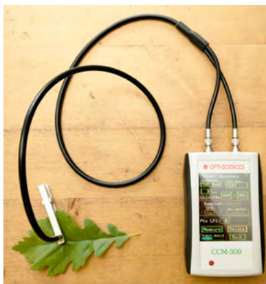
Obr. 1: Vlevo – nejrozšířenější přístroj určený k měření obsahu chlorofylu Konica Minolta SPAD 502 (Photo courtesy of Konica Minolta, Inc. All rights reserved) a vpravo – přístroj Opti-Sciences CCM-300 (foto: Rostislav Linda).
