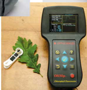
Obr. 2: Nejpoužívanější přístroje pro měření fluorescence chlorofylu; Hansatech FMS2 a model Pocket PEA stejného výrobce nahoře (© Hansatech Instruments Ltd), přístroj firmy Opti-Sciences OS30p+ dole (foto: Rostislav Linda).
