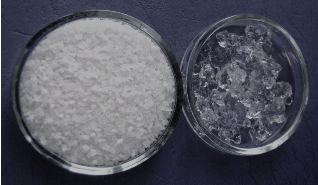
Obr. 1: Hydroabsorbent Hydrogel – vlevo v suchém, vpravo v aktivovaném stavu
