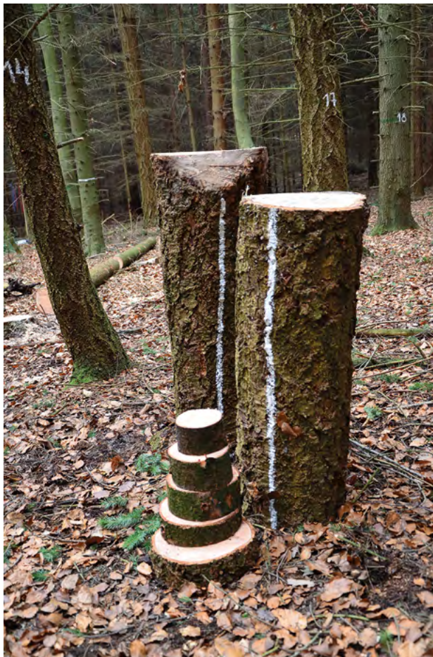
Sekce odebrané z oddenkové části kmene pro účely stanovení mechanických a fyzikálních vlastností dřeva douglasky. Kmenové kotouče pro určení konvenční hustoty dřeva.
