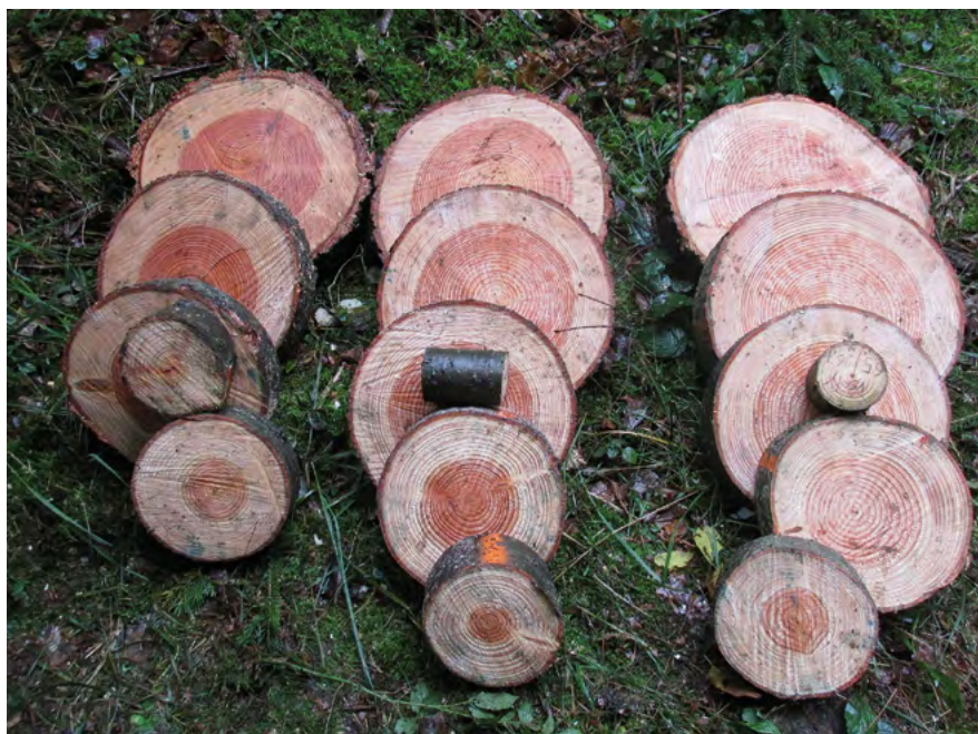
Kmenové kotouče douglasky tisolisté odebrané pro stanovení konvenční hustoty dřeva a kůry kmene.
