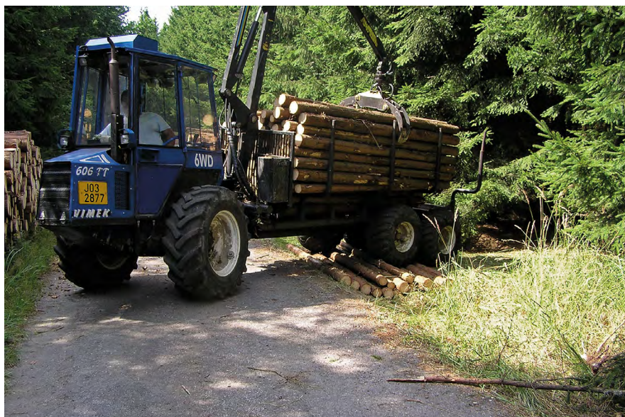
Vyvážecí souprava Vimek 606 TT, šetrné vyjíždění přes příkop z vyvážecí linky na odvozní místo (foto: Radomír Ulrich)
