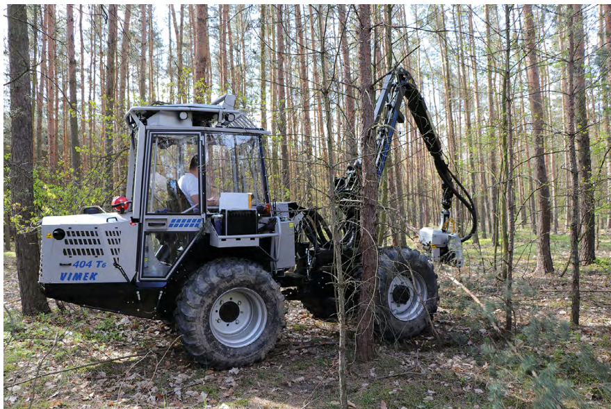
Malý harvester Vimek 404 T při práci v borovém porostu – pohled z boku (foto: archiv Lesnická práce s.r.o.)
