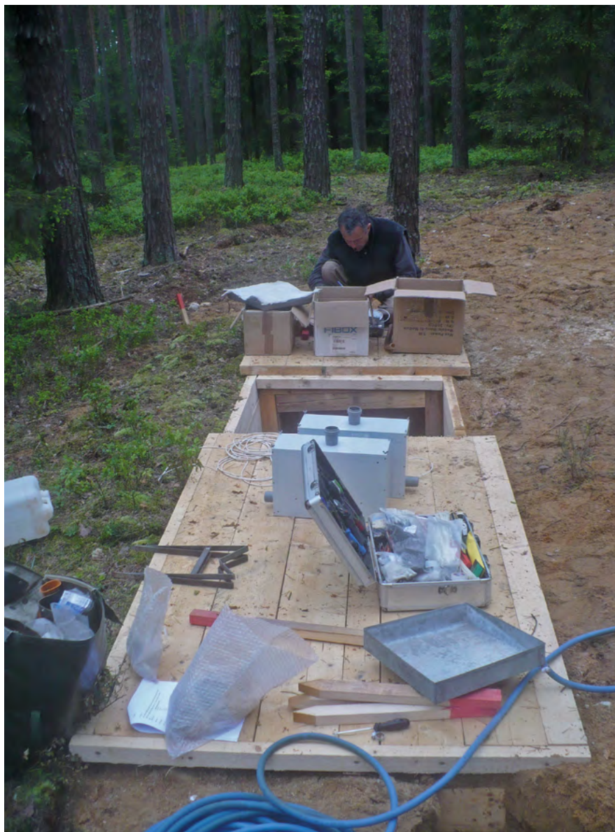
Obr. 2: Instalace meteorologické stanice a celkový pohled na osazená měřicí zařízení – plocha Kontrola
