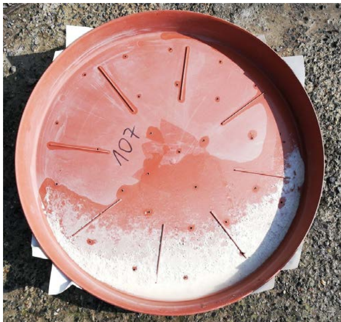
Obr. 9: Upravená odběrová nádoba pro kontrolu úplnosti zásahu (Foto: T. Čihák)
