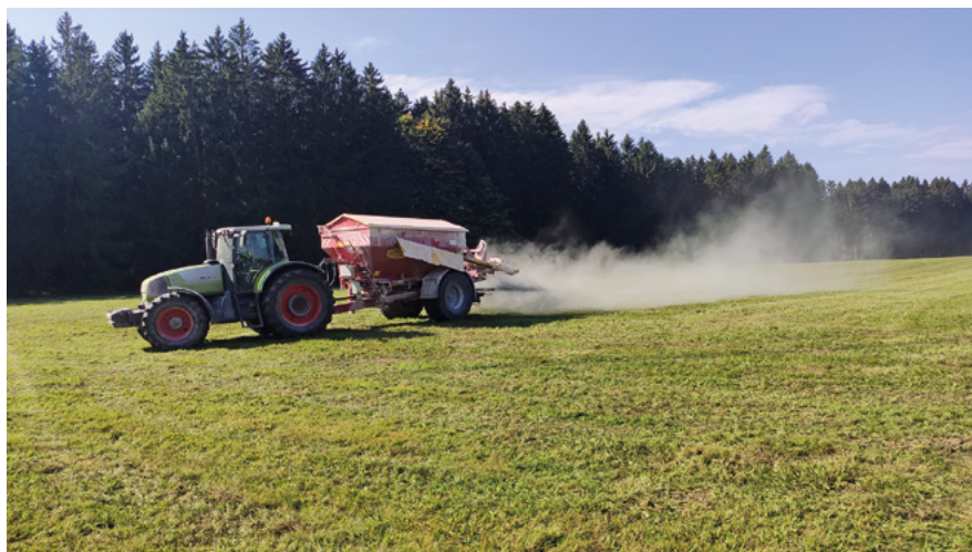
Obr. 2: Aplikace bazické silikátové moučky Brozit pomocí dánského kotoučového rozmetadla Bredal – typ K105L Auger (fotoarchiv VS Opočno: © David Šimek; Bohdalec, 5. 10. 2021)
