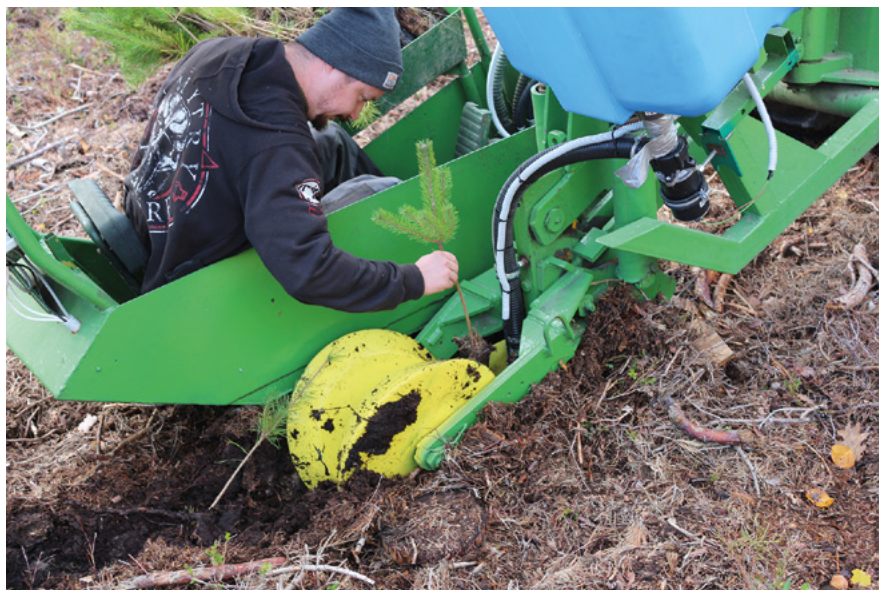
Obr. 13: Výsadba borové sazenice s využitím rýhovacího stroje s aplikací hydrogelu. Foto: M. Svatoš
