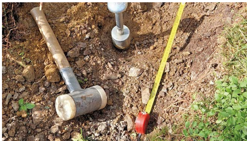
Obr. 16: Odběr neporušených půdních vzorků pro stanovení objemové hmotnosti pomocí Kopeckého válečku (Foto: V. Šrámek)
