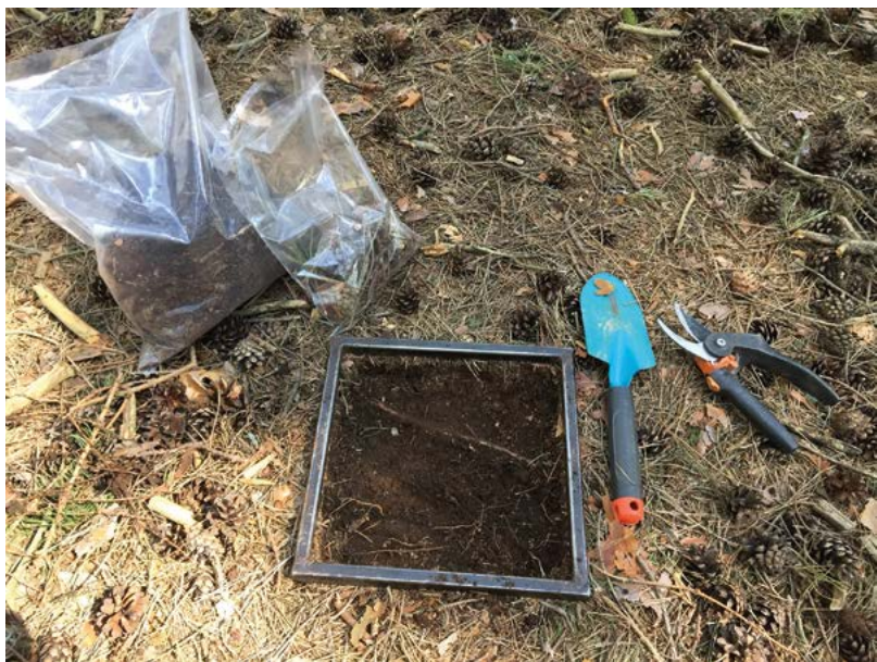
Obr. 14: Odběr vzorků organické vrstvy pomocí rámečku 25 × 25 cm pro stanovení objemové hmotnosti a zásoby humusu (Foto: V. Fadrhonsová)
