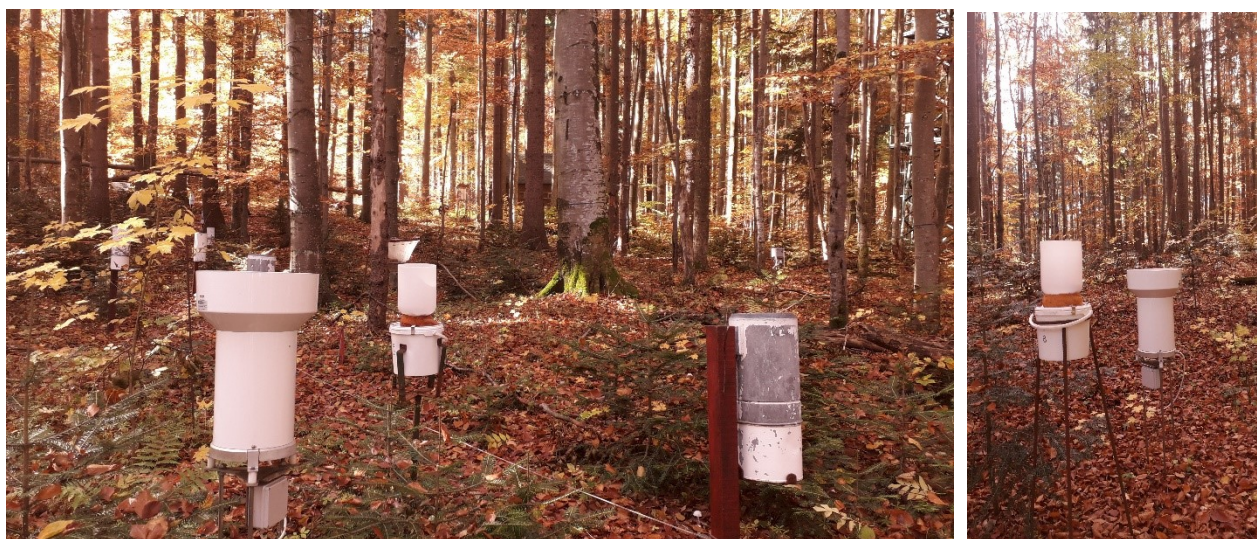
Obr. 1 Meranie kvantity podkorunových zrážok na TMP Poľana–HG. Automatický zrážkomer MetOne380 (10 ks) a depozičný kolektor (10 ks v letnom režime a 5 ks v zimnom režime)
