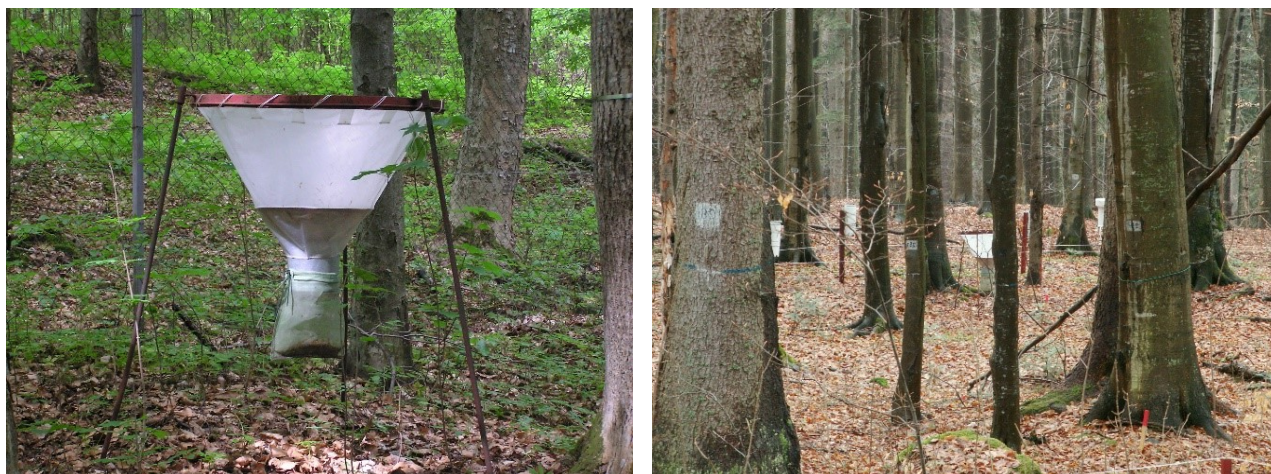
Obr. 1 Pohľad do TMP Poľana – Hukavský grúň a detail opadomeru používaného pre zber opadu (foto T. Priwitzer)
