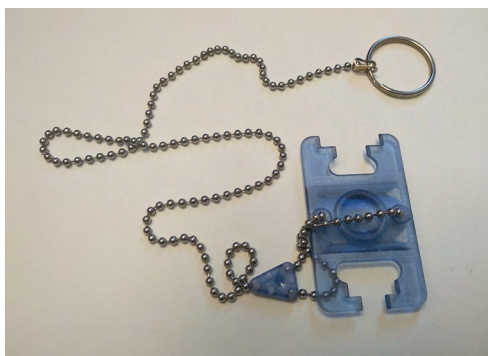
Obr. 5: Pomůcky pro relaskopování – optický klín (vlevo) a relaskopická hůl (vpravo)
